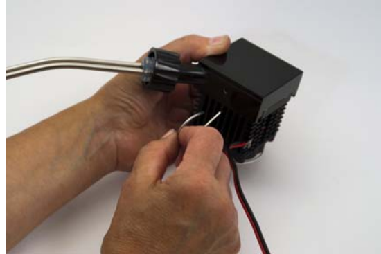
Abbildung 49 Führen Sie die Halteklammer durch die Kühlrippen des Peltier-Kühlmoduls.
