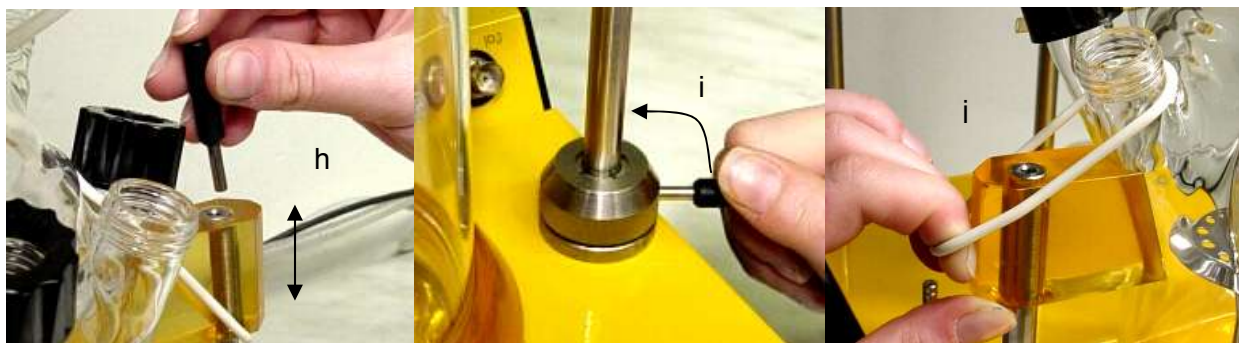
Abbildung 31 Das Fermentationsgefäß wird durch zwei seitliche Stäbe und je nach Typ einem Halterungsring auf dem MINIFOR fixiert.
