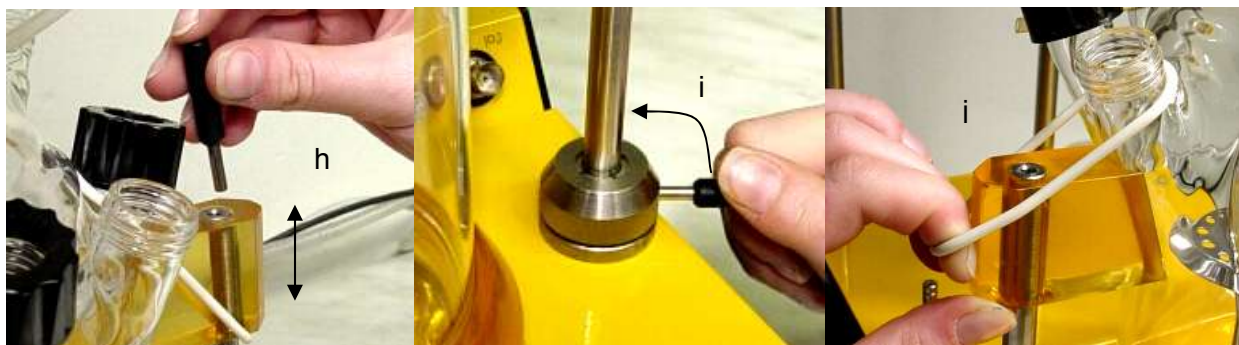
Abbildung 3 Das Fermentationsgefäß wird durch zwei seitliche Stäbe und je nach Typ einem Halterungsring auf dem MINIFOR fixiert.
