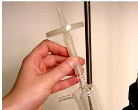
Abbildung 26 Abluftkühler mit Sterilfilter (ACHTUNG! Benutzen Sie einen viel längeren Schlauch!)
