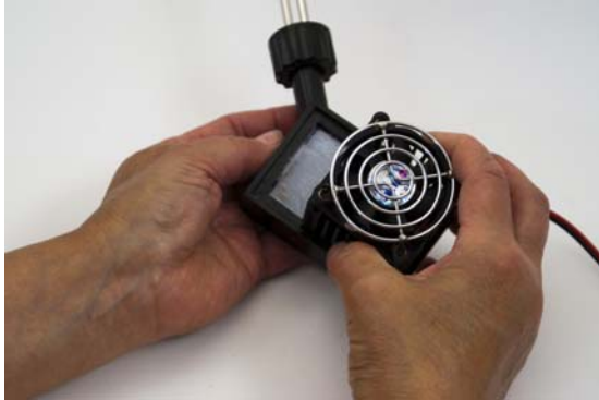
Abbildung 48 Schieben Sie das Peltier-Modul seitlich auf die Wärmetauschplatte der Kühlschleife.
