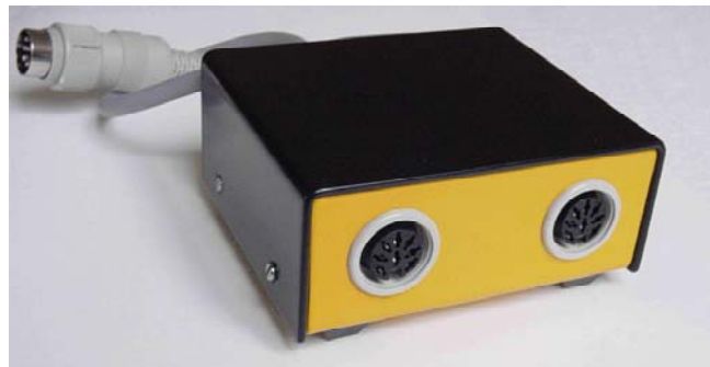
Abbildung 53 und Abbildung 54 Schliessen Sie den Peltier-Kühlsystem-Stecker in eine freie Pumpenbuchse auf der Rückseite des MINIFOR Fermenters oder in die Vierfach-Steckdose (Ar. Nr. 800202) an.
