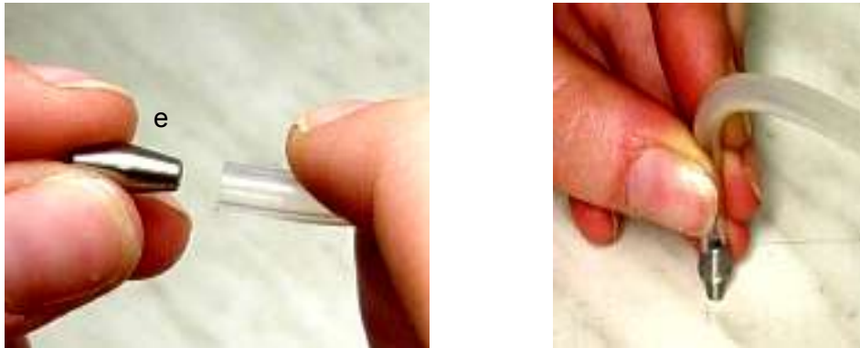
Abbildung 4 Das doppelkonische Metallrohr und der Zuluft-Schlauch: Durch Pressen auf die Tischplatte können sie den Schlauch einfacher überstülpen.
