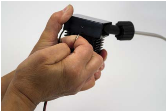
Abbildung 50 Führen Sie beide Enden der Halteklammer in die entsprechenden Löcher auf der Kühlschleife.
