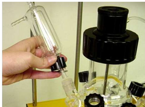
Abbildung 25 Montierter Abluftkühler wird in den Seitenhals des MINIFOR Gefäßes gesteckt
