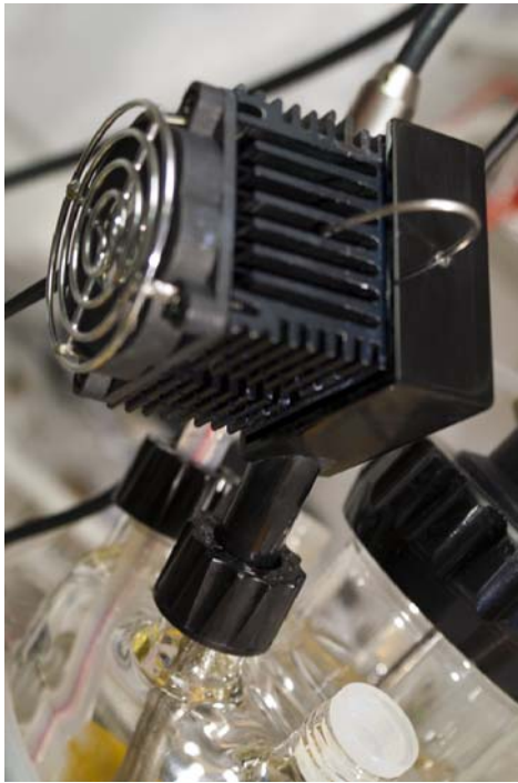
Abbildung 52 Führen Sie die Peltier-Kühlschleife in einen Seitenhals des Fermentergefässes und schrauben Sie die Schraubkappe fest.
