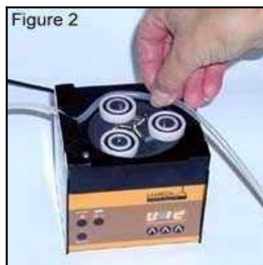
Fig. 2: Insérez le tuyau
