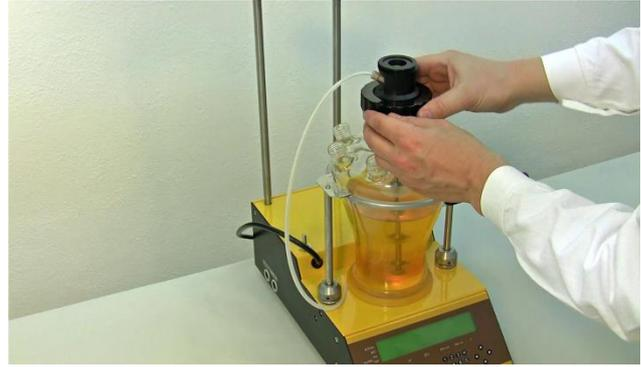
**Figure 16** Assurez-vous que la tête de l'agitateur est bien fixée et que la partie mobile en PEEK est positionnée comme sur la figure.
