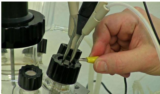
**Figure 44** Fixer l'autre côté du câble de mise à la terre avec sa pince crocodile jaune à la canule la plus longue (elle doit être en contact avec le milieu liquide).
