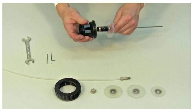
**Figure 8** Placer la tête de l'unité d'agitation par-dessus le cylindre mobile lui-même fixé à une membrane de stérilité et au tube d'agitation.
