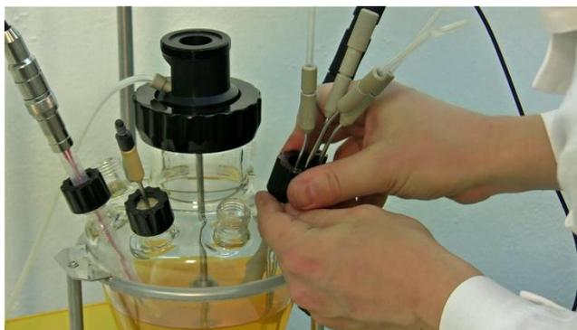
**Figure 21** Insérer l'ensemble à quatre canules dans le port de grand diamètre et adjacent à la sonde pO<sub>2</sub>. Le fixer fermement avec l'écrou à vis noir.
