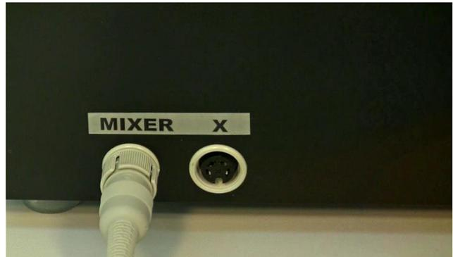
**Figure 36** Connecter le câble de l'unité d'agitation à la prise "MIXER" située sur le côté gauche de l'unité de base du fermenteur LAMBDA MINIFOR.
