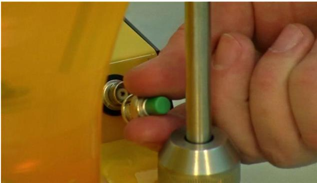
**Figure 39** Retirer le capuchon de protection du connecteur de la sonde pO<sub>2</sub> (DO) en appuyant et en la déverrouillant.
