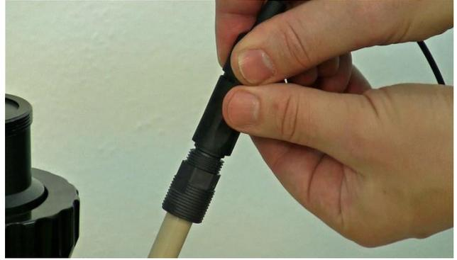
**Figure 38** La sonde de pO<sub>2</sub> (Option pour MINIFOR Start-Up Kit) est connectée à l'unité de contrôle par son câble.
