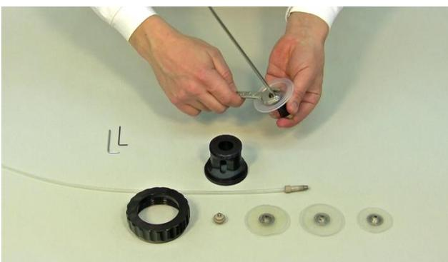
**Figure 7** Serrer fermement l'écrou, sur le côté concave de la membrane de stérilité en silicone qui, à son tour, maintient fermement le cylindre mobile contre la membrane
