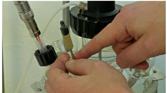
**Figure 29** Insérer le bouchon avec la soupape de sécurité dans l'orifice de la cuve, par exemple à côté de la sonde de pH.
