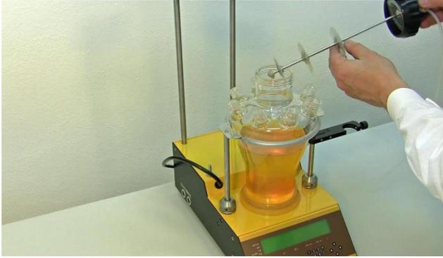
**Figure 15** Placer l'unité d'agitation avec ses disques et le diffuseur dans le récipient et fixer l'écrou de serrage sur le filetage de la cuve.
