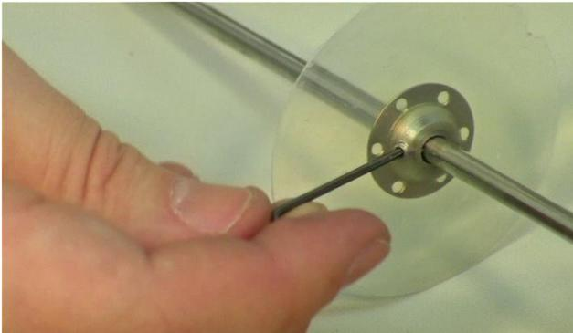
**Figure 11** Fixer les disques d'agitation sur le tube d'agitation, qui sert aussi pour l'arrivée d'air, avec l'une des clés fournies.
