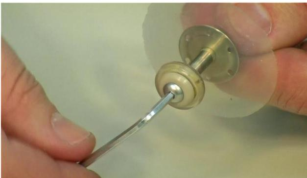
**Figure 13** Fixation du diffuseur d'air autonettoyant à l'extrémité du tube d'agitation.
