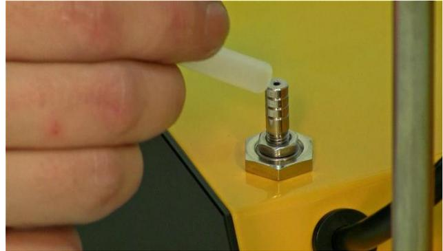
**Figure 34** Le tuyau d'arrivée d'air stérilisé avec son filtre est fixé au connecteur situé vers l'avant à gauche du fermenteur. Ce tuyau peut être maintenu par une pince.
