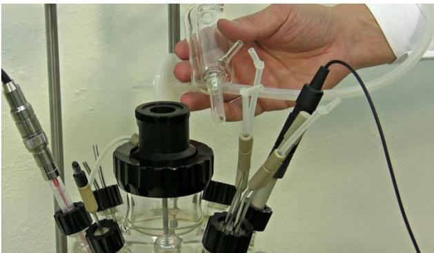
**Figure 17** Le condenseur en verre pour la sortie des gaz et le filtre de sortie des gaz doivent être stérilisés avec le récipient MINIFOR.
