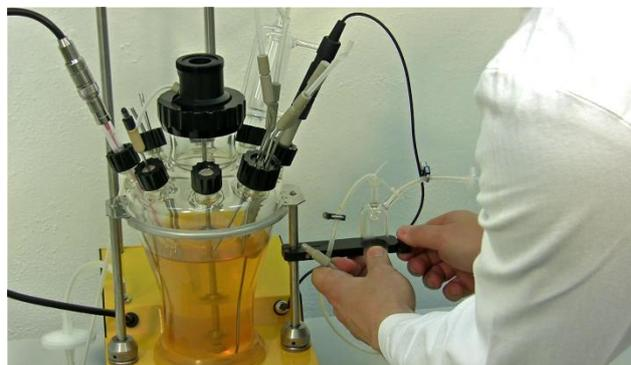
**Figure 22** Placer le dispositif d'échantillonnage stérile sur son support et le fixer avec la vis latérale.
