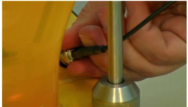
**Figure 40** Fixer le connecteur de la sonde pO<sub>2</sub> (DO) dans la prise en le faisant tourner et en appuyant pour le verrouiller.
