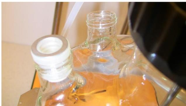
**Figure 19** Joint de silicone surmonté par une rondelle en acier inoxydable
