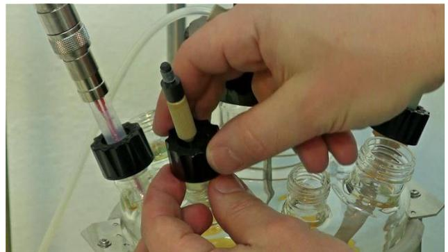
**Figure 31** Enfin, placer le bouchon fileté noir et le serrer fermement en le tournant dans le sens des aiguilles d'une montre.
