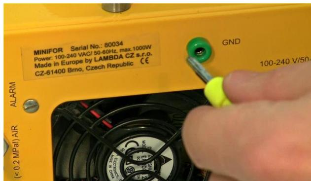
**Figure 42** Insérer le connecteur vert du câble noir dans la prise "GND" située à l'arrière de l'unité de base MINIFOR pour la mise à la terre.
