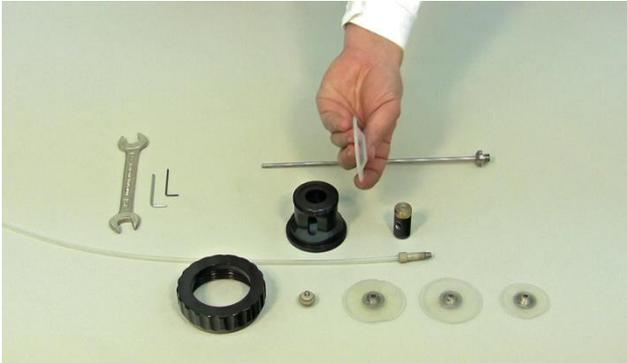
**Figure 3** Composition de l'agitateur. La pièce tenue dans la main est la membrane de silicone assurant la stérilité.
