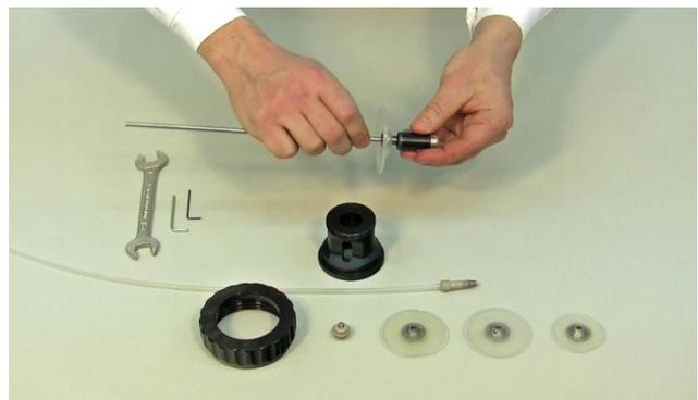
**Figure 6** Le cylindre mobile doit être fixé à l'extrémité filetée de la tige d'agitation mobile. Visser le cylindre qui sert de couplage magnétique au bout du tube.
