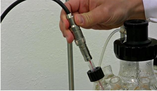
**Figure 37** La sonde de pH & température est connectée à l'unité de contrôle par son câble.
