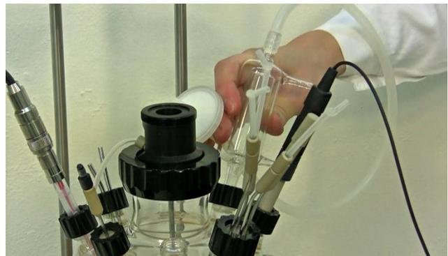
**Figure 18** Insérez le condenseur de la sortie des gaz dans l'orifice équipé d'un bouchon ouvert, une rondelle et un bouchon à vis noir. Sélectionnez un port qui dispose de suffisamment d'espace libre pour la mise en place.
