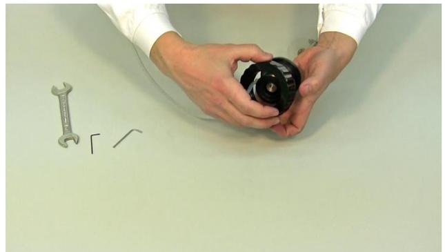
**Figure 14** Placer l'écrou de serrage sur la tête de l'unité d'agitation.
