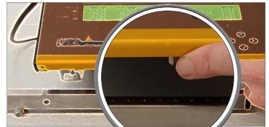
Module de balance miniature (pointe métallique) placé sous le MINIFOR pour rendre la mesure du poids facile
