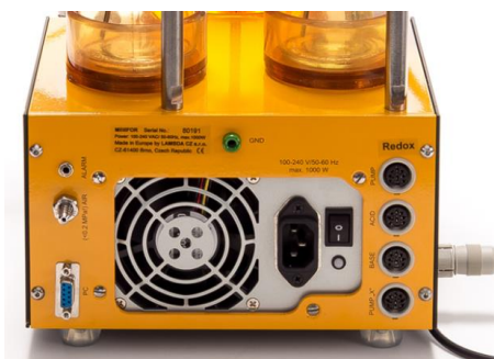
Figure 2 Le bioréacteur de laboratoire LAMBDA MINIFOR : La prise « PUMP » est située à l'arrière.
