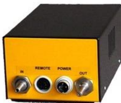
Figure 6 Les buses « IN » et « OUT » à l'arrière du LAMBDA CARBOMETER : « IN » pour la sortie de gaz du bioréacteur ; « OUT » pour brancher METHAMETER, OXYMETER, MASSFLOW S ou un autre instrument de laboratoire.
