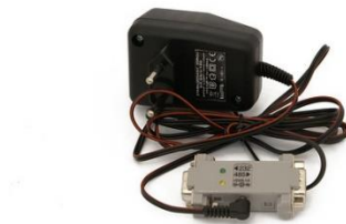
Figure 9 L'alimentation pour convertisseur RS-232/485 et convertisseur RS-232/485
