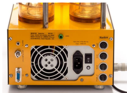
Figure 11 La prise « PUMP » est située à l'arrière bioréacteur LAMBDA MINIFOR
