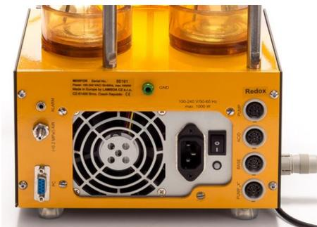
Figure 2 Le fermenteur de laboratoire LAMBDA MINIFOR : La prise « PUMP » est située à l'arrière.
