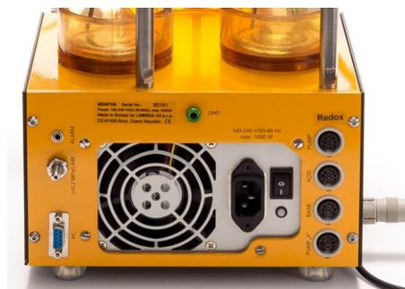
Figure 11 La prise « PUMP » est située à l'arrière fermenteur LAMBDA MINIFOR
