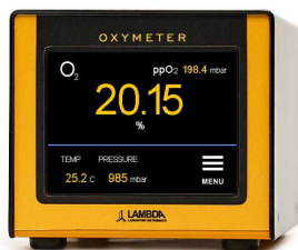
OXYMETER touch misst O 2 -Konzentration im Abgas
