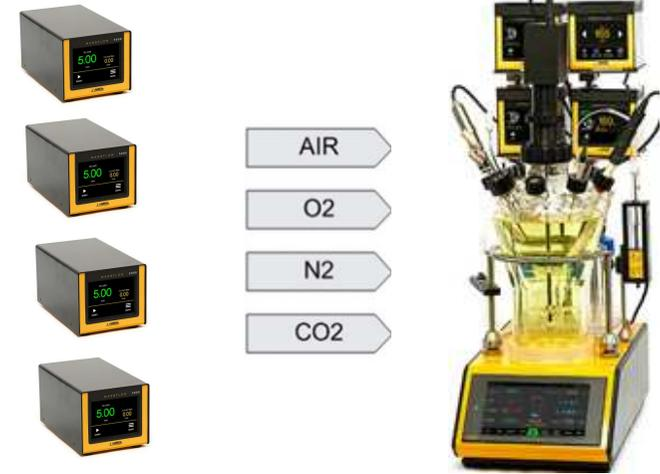
Un régulateur MASSFLOW (air/N<sub>2</sub>) est inclus dans l'unité de contrôle.
