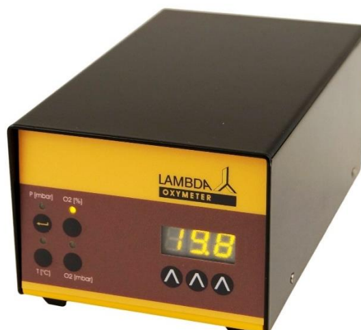
Figure 7 Exemple : LAMBDA OXYMETER affiche la concentration O 2 : La LED « O 2 [%] » est allumée.
