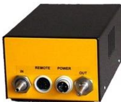
Figure 6 Les buses « IN » et « OUT » à l'arrière du LAMBDA OXYMETER : « IN » pour la sortie de gaz du bioréacteur ; « OUT » pour brancher METHAMETER, CARBOMETER, MASSFLOW S ou un autre instrument de laboratoire.
