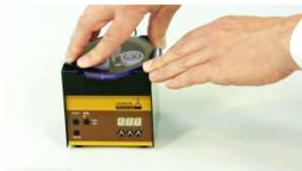
**Abbildung 1-3** Drehen Sie die transparente PVC-Abdeckung auf dem Kopf der Pumpe entweder im oder gegen den Uhrzeigersinn, um die Schlauchabdeckung zu entfernen.
