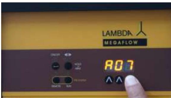
**Abbildung 4-5** Um die Adresse der Laborpumpe für die digitale Fernsteuerung zu ändern, drücken Sie die Tasten ↑↑↑ unter der Pumpenanzeige, bis die erwünschte Adresse angezeigt wird.
