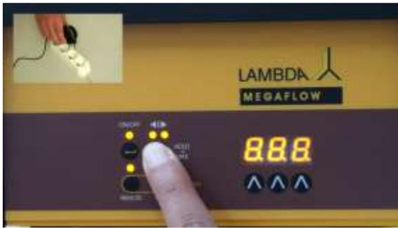
**Abbildung 4-3** Trennen Sie die Laborpumpe vom Stromnetz. Halten Sie die Richtungstaste ◀▶ gedrückt und schließen Sie die Pumpe wieder an das Stromnetz an.
