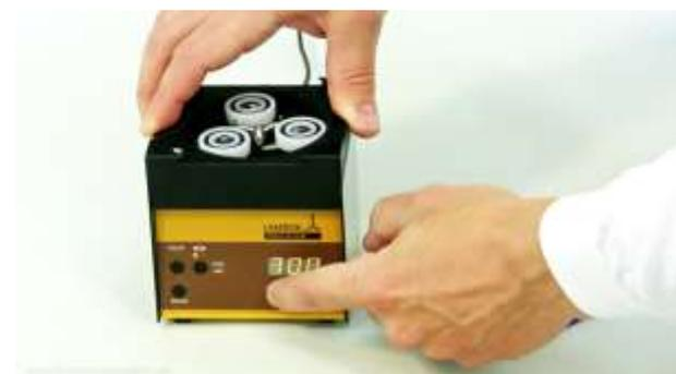
**Abbildung 1-4** Zum Einlegen des Pumpenschlauchs wird die Rotationsgeschwindigkeit mit den Pfeiltasten "AAA" unterhalb der LED-Anzeige auf etwa 700 erhöht. (Der Schlauch kann im Geschwindigkeitsbereich von 300 bis 700 eingelegt werden.)
