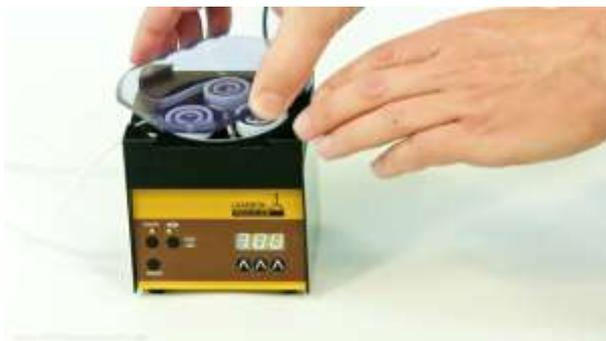
**Abbildung 1-9** Legen Sie die durchsichtige Abdecken zurück auf den Pumpenkopf.
