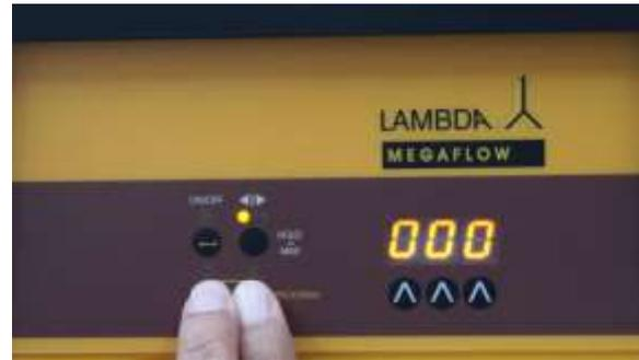
**Abbildung 2-16** Der Durchsatz (**000**) des nächsten Schrittes, der nicht mehr programmiert werden wird, erscheint auf der Anzeige der Schlauchpumpe.
