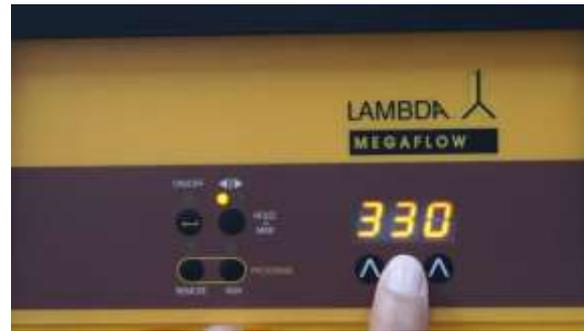
**Abbildung 2-4** Die Pumpengeschwindigkeit für den ersten Programmschritt wird mit den Tasten **^^^** unterhalb der Anzeige eingegeben. Die Werte zwischen 0 und 999 entsprechen 0 bis 100% der max. Geschwindigkeit.
