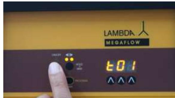
**Abbildung 2-6** Drücken Sie die **ON/OFF** Taste. Auf der Anzeige erscheint für einige Sekunden "t01". Die Pumpe zeigt damit an, dass die Dauer (in Minuten) des ersten Programmschritts mit den Tasten **^^^** eingegeben werden kann.
