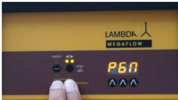
**Abbildung 2-1** Drücken Sie gleichzeitig die Tasten **REMOTE** und **RUN** bis "PGM" auf dem Display der Schlauchpumpe erscheint.
