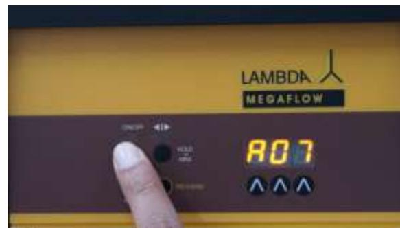
**Abbildung 4-6** Um die gewählte Pumpenadresse zu speichern, betätigen Sie die ON/OFF Taste der Schlauchpumpe.
