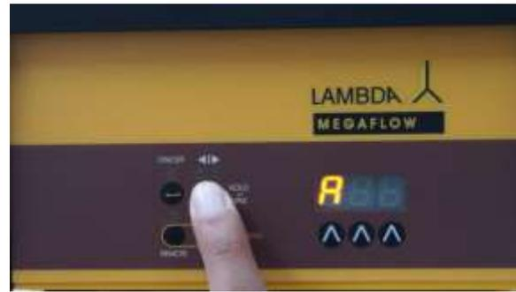
**Abbildung 4-4** Auf der Anzeige der Pumpe erscheinen "A" und zwei Ziffern. Die Nummer zwischen 00 und 99 ist die aktuelle Pumpenadresse.
