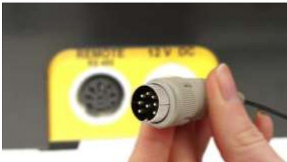
**Abbildung 4-1** Für die Fernsteuerung der Laborpumpe schliessen Sie den 8-poligen Stecker des Fernsteuerungskabel an die "Remote" Buchse auf der Rückseite der Pumpe an.
