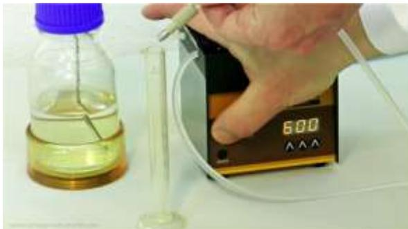
**Abbildung 3-1** Schalten Sie die Pumpe ein und sammeln Sie die geförderte Flüssigkeit während einer gemessenen Zeit (60 Sekunden) in einem Messzylinder.
