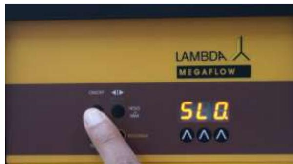
**Abbildung 1-20** Bestätigen und speichern Sie den gewählten Geschwindigkeitsmodus durch Drücken der **ON/OFF** Taste der MEGAFLOW Pumpe.
