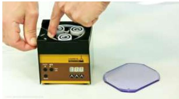
**Abbildung 1-8** Drücken Sie den Schlauch in den vorderen Spalt am Pumpenkopf.
