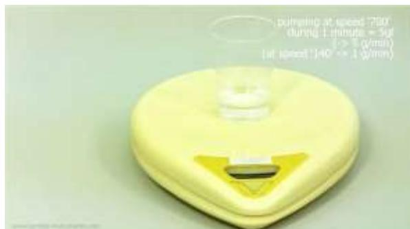
**Abbildung 3-6** Wägen Sie das Becherglas mit der gesammelten Flüssigkeit. Beispiel: Es werden 5 g Flüssigkeit nach 60 Sekunden Pumpen bei Geschwindigkeit 700 gewogen. Der Durchsatz bei einer Geschwindigkeitseinstellung von 700 beträgt also 5 g/min. Mit einem einfachen Dreisatz können Sie nun von den Geschwindigkeitseinstellungen auf den Durchsatz schließen.
