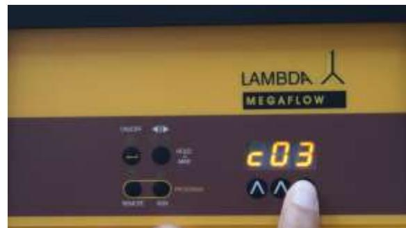
**Abbildung 2-18** Falls Sie das eingegebene Programm dreimal durchlaufen lassen wollen, bevor die Schlauchpumpe stoppen wird, dann ändern Sie die Ablaufszahl mit Hilfe der **^ ^ ^** Tasten auf „**c03**“.
