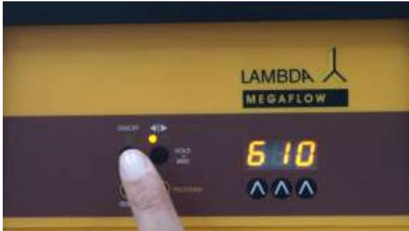
**Abbildung 1-11** Drücken Sie die ON/OFF Taste, um die Schlauchpumpe einzuschalten
