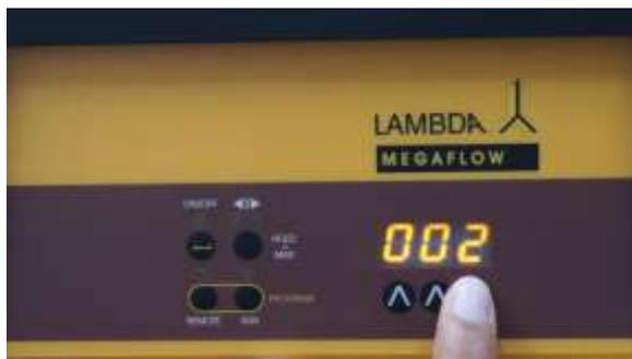
**Abbildung 2-7** Der Wert für die Dauer (von 0 bis 999 Minuten oder von 00.0 bis 99.9 Minuten) des ersten Programmschritts wird über die Tasten **^^^** unterhalb der Pumpenanzeige eingegeben.
