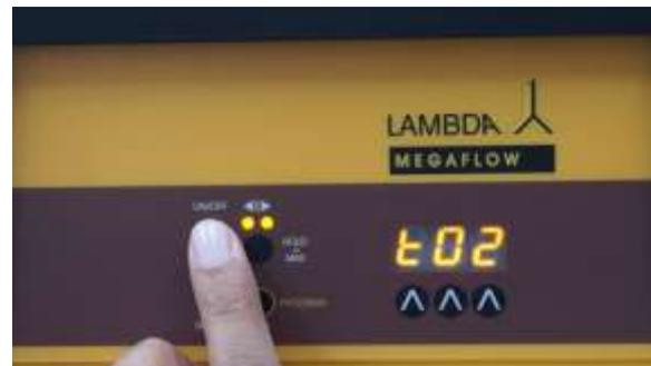
**Abbildung 2-12** Drücken Sie wieder die **ON/OFF** Taste. "t02" erscheint kurz auf dem Display der Schlauchpumpe.
