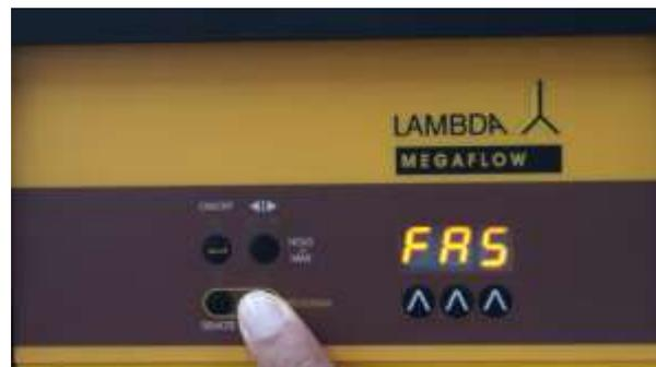
**Abbildung 1-18** Auf der Anzeige wird **FAS** für den schnellen Geschwindigkeitsmodus oder der zuletzt benutzte Modus angezeigt (**FAS / SLO.**).
