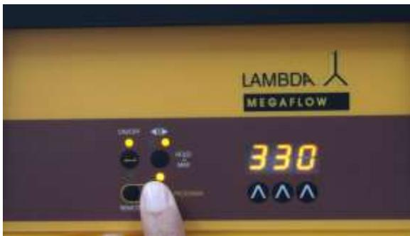
**Abbildung 2-20** Um das Programm zu starten, drücken Sie die **RUN** Taste der Schlauchpumpe. Die LED von RUN und die LED von ON/OFF leuchten beide. Um das laufende Programm abbrechen, drücken Sie die **RUN** Taste. Die LED von RUN und die LED von ON/OFF erlöschen.
