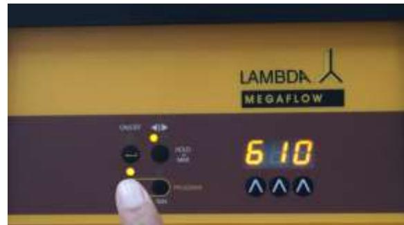
**Abbildung 4-2** Betätigen Sie die REMOTE Taste der Laborpumpe. Die entsprechende LED leuchtet auf und auf der Anzeige erscheint der ungefähre Wert der Spannung des geräteexternen Signals an.
