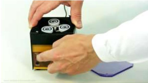
**Abbildung 1-5** Drücken Sie die EIN / AUS-Taste und wählen Sie durch Drücken der Taste ◀ | ▶ die Drehrichtung der Schlauchpumpe.
