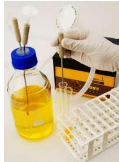
**Abbildung 9-1** LAMBDA MEGAFLOW mit Fusschalter zum sterilen Dosieren von Flüssigmedien in der Mikrobiologie.
