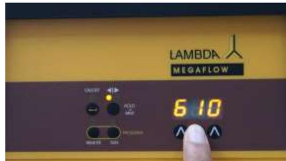
**Abbildung 1-14** Mit jeder  $\wedge$  Pfeiltaste wird die entsprechende Ziffer der Pumpengeschwindigkeit darüber geändert.
