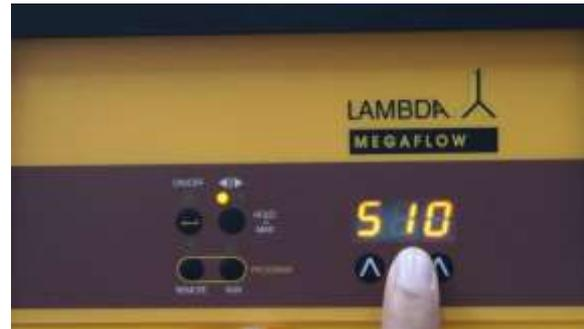
**Abbildung 2-10** Geben Sie die Pumpengeschwindigkeit für den zweiten Programmschritt mit Hilfe der **^ ^ ^** Tasten an der Schlauchpumpe ein.
