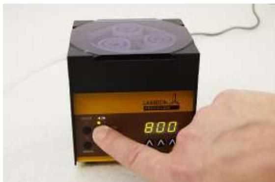
**Abbildung 1-15** Die leuchtende LED in Richtung  $\blacktriangleleft$  zeigt die Drehung im Uhrzeigersinn an.
