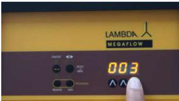
**Abbildung 2-13** Geben Sie die Dauer (Minuten) des zweiten Programmschrittes ein.
