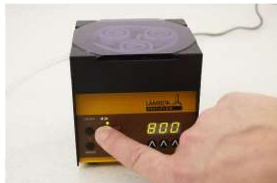
**Abbildung 1-16** Die leuchtende LED in Richtung  $\blacktriangleright$  zeigt die Drehung im Gegenuhrzeigersinn an.
