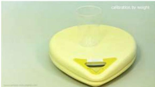
**Abbildung 3-3** Trieren Sie mit dem Becherglas (Waage mit Becherglas zeigt 0.000 g an).
