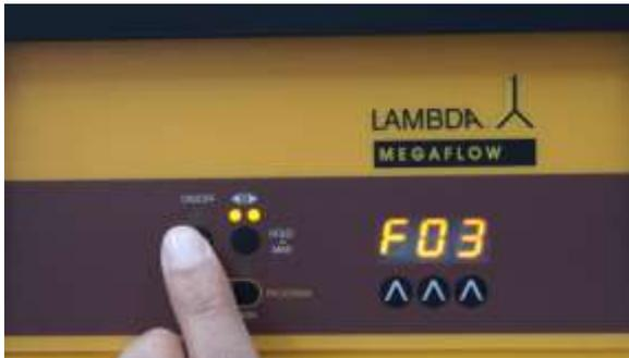
**Abbildung 2-15** Sobald Sie die Dauer des letzten Programmschrittes eingegeben haben, drücken Sie die **ON/OFF** Taste.
