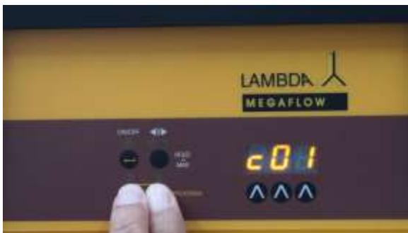
**Abbildung 2-17** Drücken Sie gleichzeitig die **Remote** und **Run** Tasten. Auf dem Display erscheint "**c01**". Die Schlauchpumpe zeigt damit an, dass das eingegebene Programm nur einmal durchgeführt wird und die Pumpe dann stoppt.
