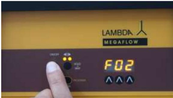
**Abbildung 2-9** Drücken Sie die **ON/OFF** Taste. "F02" erscheint kurz auf der Anzeige. Die Pumpe zeigt damit an, dass die Durchflussrate (Geschwindigkeit) des 2. Programmschritts eingegeben werden kann.
