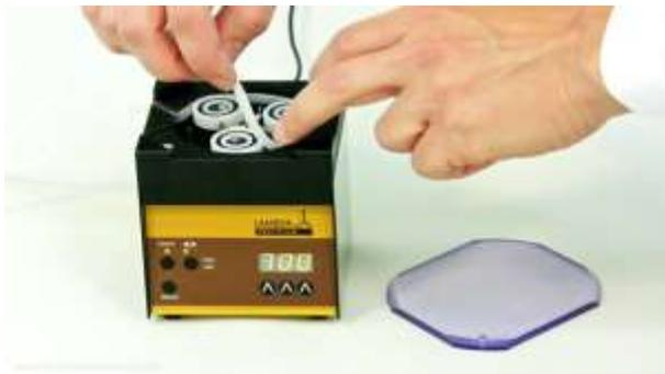
**Abbildung 1-7** Führen Sie den Schlauch um die langsam drehenden Kunststofflager in Richtung des vorderen Spalts (oben auf der Pumpe)
