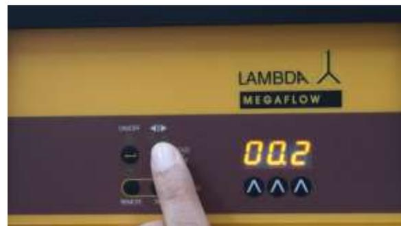
**Abbildung 2-8** Durch die Betätigung der Taste **<|>** wird die **Zeitauflösung** ausgewählt: 1 Minute oder 0.1 Minuten. In der 0.1 Minuten-Zeitauflösung wird eine Kommastelle im Wert angezeigt: z.B. "00.2". Die Zeitauflösung **kann für jeden einzelnen Programmschritt gewählt werden.**
