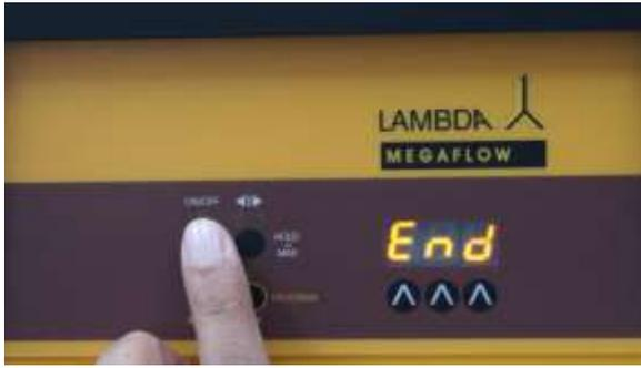
**Abbildung 2-19** Drücken Sie die **ON/OFF** Taste bis auf der Anzeige der Schlauchpumpe "End" erscheint. "End" bestätigt und speichert das Programm.
