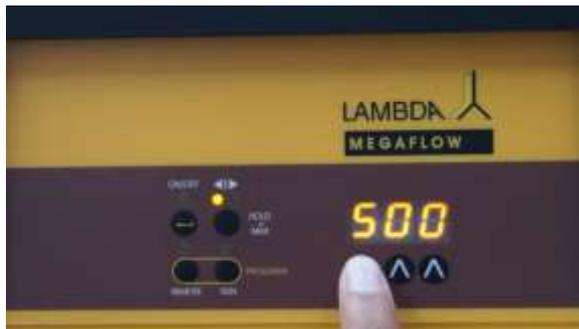
**Abbildung 1-13** Mit den  $\wedge \wedge \wedge$  Tasten wird die Pumpengeschwindigkeit eingestellt.
