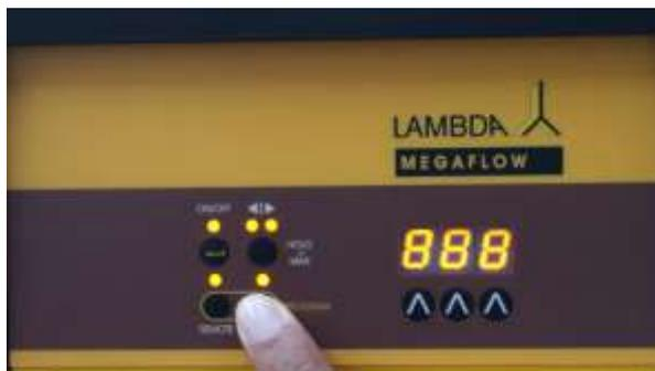
**Abbildung 1-17** Für die Änderung des Geschwindigkeitsmodus schliessen Sie das Netzteil der MEGAFLOW Pumpe an und drücken gleichzeitig die **RUN** Taste auf dem Bedienfeld.
