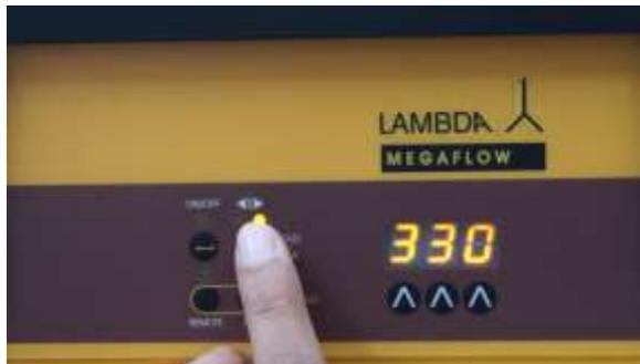
**Abbildung 2-5** Wählen Sie mit der Richtungstaste **<|>** die Fließrichtung (Uhrzeigersinn / Gegenuhrzeigersinn).
