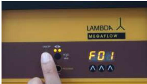
**Abbildung 2-3** Drücken Sie die **ON/OFF** Taste. "F01" erscheint kurz auf der Anzeige. Die Pumpe zeigt damit an, dass die Durchflussrate (Geschwindigkeit) des ersten Programmschritts eingegeben werden kann.
