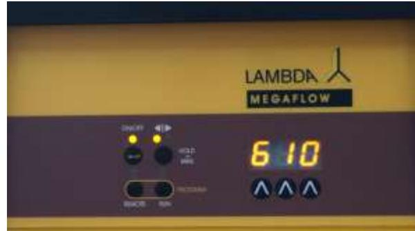
**Abbildung 1-12** Die Schlauchpumpe läuft in der zuletzt vorgegebener Flussrichtung und Geschwindigkeit.
