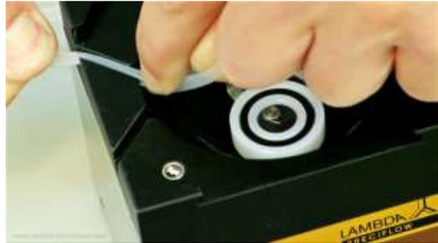
**Abbildung 1-6** Oben auf der Schlauchpumpe drücken Sie den Schlauch in den hinteren Spalt. Dünne Schläuche werden vollständig nach unten eingeschoben.
