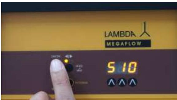
**Abbildung 2-11** Wenn Sie die **◀|▶** Taste zur Auswahl der Pumprichtung nicht betätigen, dann wird automatisch das Pumpen im Uhrzeigersinn als Standard eingestellt bleiben. Die LED der Richtungsanzeige **◀|** leuchtet auf.
