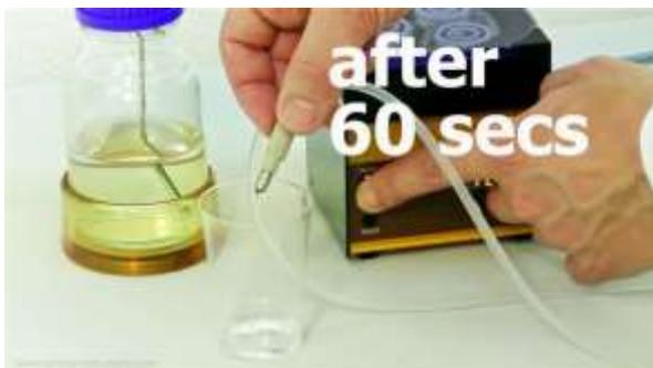
**Abbildung 3-5** Die geförderte Flüssigkeit wird im zuvor auf der Waage tarierten Becherglas während einer gemessenen bzw. vorprogrammierten Dauer (60 Sekunden) gesammelt.
