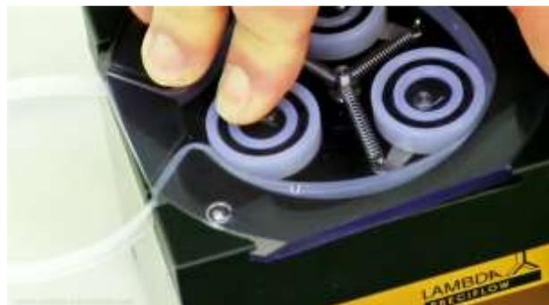
**Abbildung 1-10** Drehen Sie die Abdeckung so, dass die in der linken vorderen Ecke der Schlauchpumpe eingebettete Stahlkugel in die Aussparung des Deckels passt.
