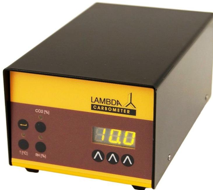
CARBOXÍMETRO mide la **concentración de CO<sub>2</sub>** en el gas de salida/corriente exhausta.
