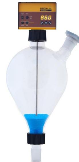
При больших объёмах во время дозирования сыпучих веществ для пополнения дозатора используется боковая горловина. Запасной резервуар также может быть оснащён газовой насадкой с желаемыми газами (например N<sub>2</sub>, Ar и т.д.), чтобы произвести очистку резервуара от веществ чувствительных к воздействию кислорода или от гигроскопических веществ.
