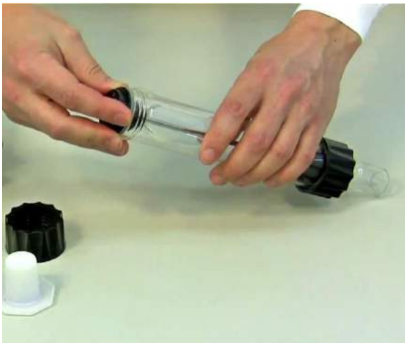
Abb. 7: Das Zentrierteil mit der Dichtungsscheibe wird auf die Achse des Verteilers gesetzt.
