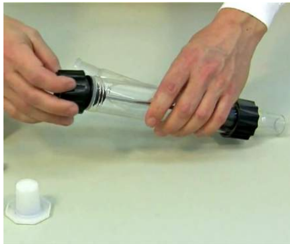
Abb. 8: Das Zentrierteil wird auf der Verteilerachse gesichert, indem die Schraubkappe auf den Glastubus verschraubt wird.
