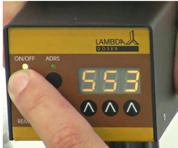
Abb. 14: Die Zugabe des Feststoffs wird durch die Betätigung der ON/OFF Taste gestartet. Das Aufleuchten der entsprechenden LED zeigt an, dass zudosiert wird.
