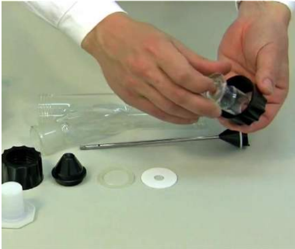
Abb. 1: Das Schliffteil wird durch die Schraubkappe geschoben.
