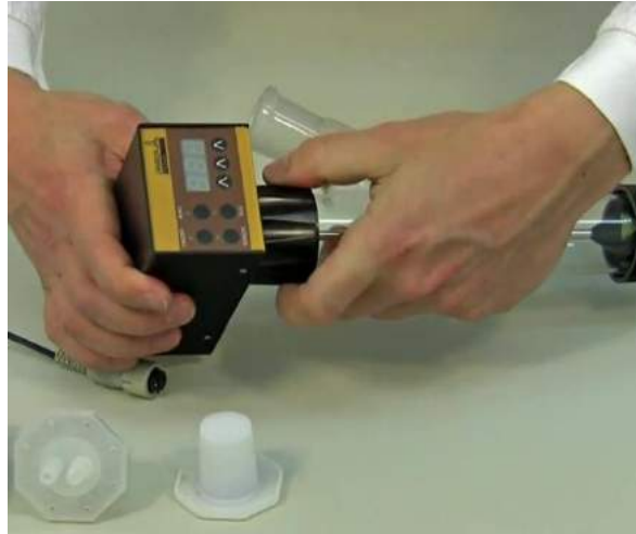
Abb. 10: Die Motoreinheit wird durch Druck und einer leichten Drehung bis zum Einrasten des Stifts mit der Verteilerachse gekoppelt. Das gewährt die perfekte Abdichtung des LAMBDA DOSER bzw. LAMBDA Hi-DOSER Pulverdosierers und den optimalen Druck des Verteilers gegen die Teflonscheibe am Boden des Glastubus.
