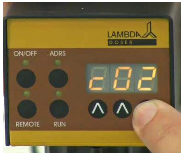
Abb. 28: Um das gleiche Programm zu wiederholen, wird die Zyklenzahl (von 0 bis 99) mithilfe der ▲▲▲ Tasten gewählt.
