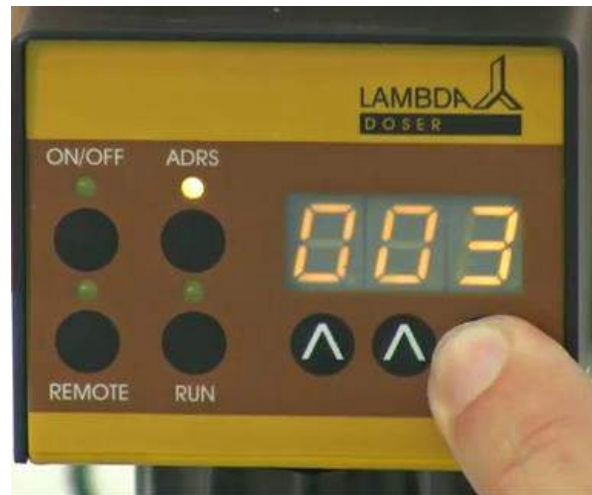
Abb. 20: Der Wert der Dauer des ersten Programmschrittes wird über die drei Tasten ΛΛΛ unterhalb der Anzeige eingegeben. (Die Werte entsprechen der Dauer von 0 bis 999 Minuten.)
