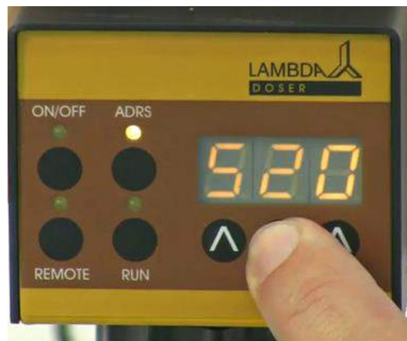
Abb. 22: Jetzt kann die Durchflussrate des zweiten Programmschrittes über die drei Tasten ΛΛΛ unterhalb der Anzeige eingegebene werden.
