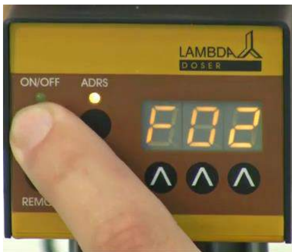
Abb. 21: Durch die Betätigung der ON/OFF Taste wird der Wert gespeichert. „F02“ erscheint kurz auf der Anzeige.
