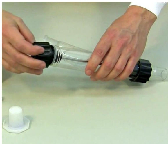
Figure 1-8: Fixer sur le récipient en verre la pièce de centrage et l'axe du distributeur à l'aide du bouchon à vis.
