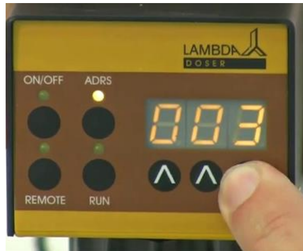
Figure 2-6: Entrer la durée souhaitée pour le premier pas de programmation à l'aide des boutons ▲▲ sous l'afficheur (de 0 à 999 minutes, ou 00,0 à 99,9 minutes). En appuyant sur le bouton ADRS , il est possible de choisir la résolution du temps correspondant soit à 1 minute soit 0,1 minute. Dans la résolution de temps de 0,1 minutes un point s'affiche, par exemple "00.1".
