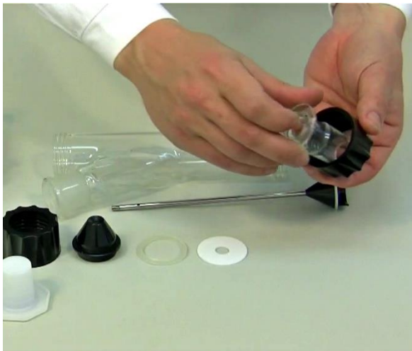
Figure 1-1: Insérer la pièce en verre inférieure dans le bouchon fileté SVL 42.
