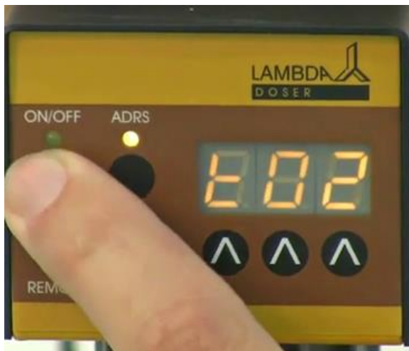
Figure 2-9: Appuyer sur la touche ON/OFF . Le symbole " t02 " apparaît brièvement sur l'écran.
