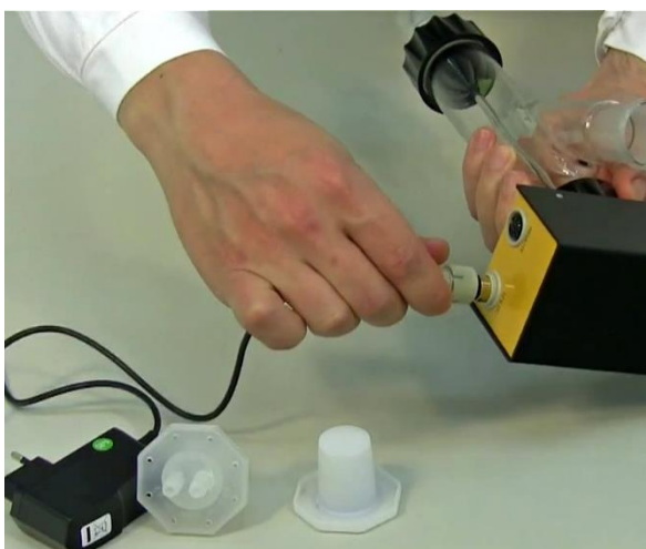
Figure 1-11: Fixer le connecteur 12 V de l'alimentation sur la prise DC de l'unité motorisée et brancher l'alimentation au secteur.
