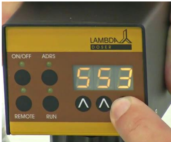
Figure 1-13: Sélection de la vitesse d'addition de poudre à l'aide des touches \wedge \wedge \wedge .
