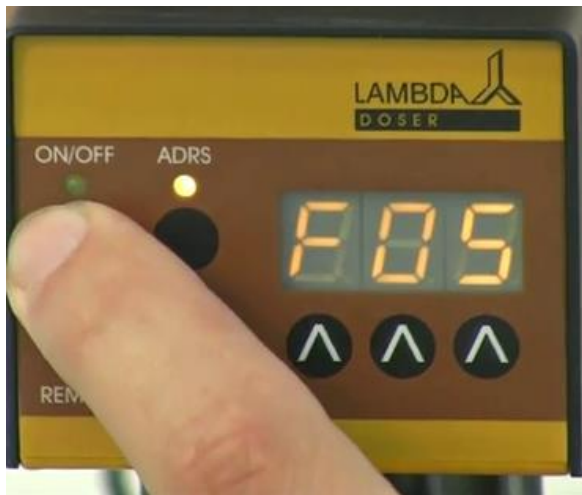
Figure 2-11: Après avoir entré la durée du dernier pas, appuyer sur le bouton ON/OFF . Le numéro (par exemple "F05") du pas apparaît sur l'écran, suivi du débit (000).
