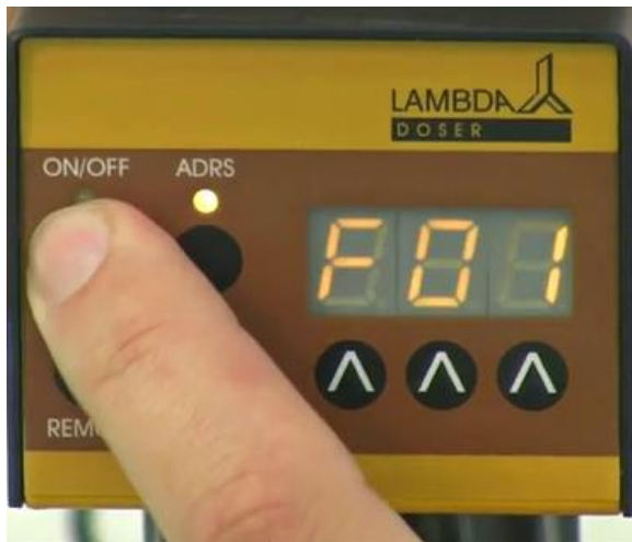
Figure 2-3: Appuyer sur le bouton ON/OFF . L'indication "F01" apparaît pendant un court instant sur l'écran pour indiquer que vous pouvez entrer la première valeur de débit (vitesse).
