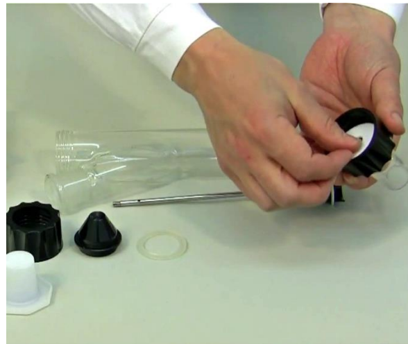
Figure 1-2: Placer le disque de téflon sur la pièce de verre (NS 29/32) dans le bouchon.
