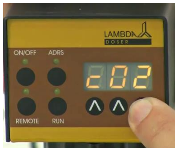
Figure 2-14: Si vous souhaitez répéter le même programme plusieurs fois, il suffit d'incrémenter le nombre de cycles (par exemple "c02" correspond à 2 cycles) en appuyant sur les touches ^ ^ ^ sous l'affichage (de 0 à 99 cycles). Le programme peut être répété jusqu'à 99 fois, ce qui correspond à "c99" sur l'affichage. Si vous entrez 0 (affichage "c00"), le programme sera exécuté en continu (boucle infinie).
