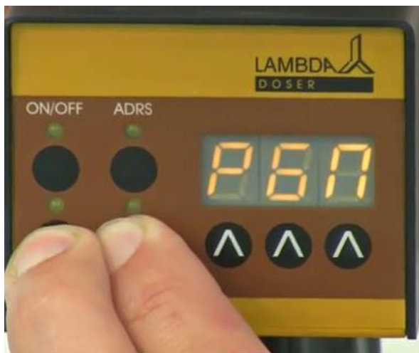
Figure 2-1: Appuyer simultanément sur les boutons RUN et REMOTE jusqu'à apparition du message "PGM".
