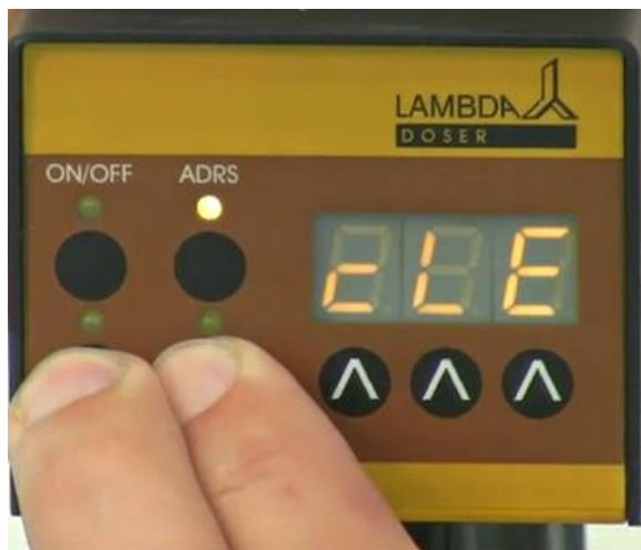
Figure 2-2: En maintenant la pression sur les touches RUN et REMOTE le message "CLE" apparaît après le message "PGM".
