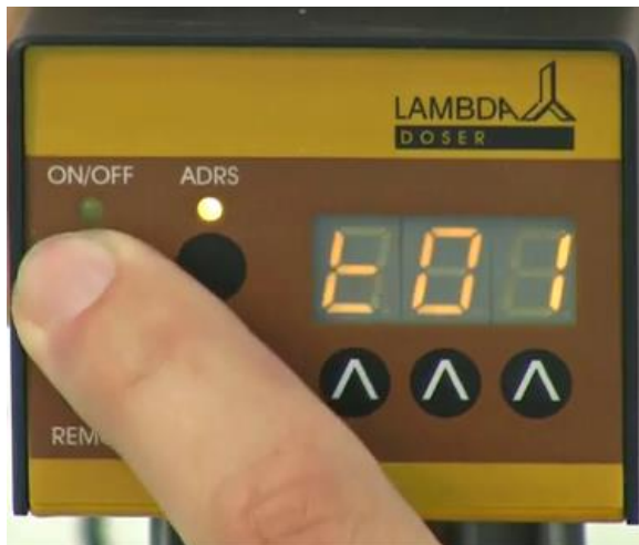
Figure 2-5: Appuyer à nouveau sur la touche ON/OFF . L'indication "t01" apparaît pendant quelques secondes sur l'écran pour indiquer que vous pouvez programmer la durée du premier pas de programmation par incréments de 0.1 minute.
