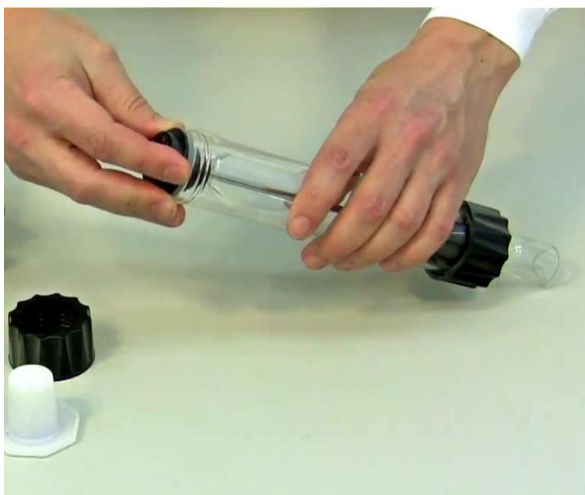
Figure 1-7: Placer la partie de centrage avec son joint en caoutchouc sur l'axe du distributeur.
