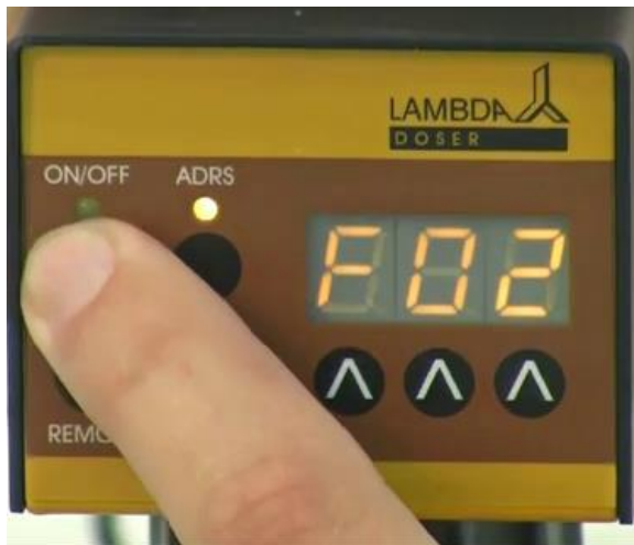
Figure 2-7: Appuyer ensuite à nouveau sur le bouton ON/OFF . L'indication " F02 " apparaît brièvement sur l'écran.
