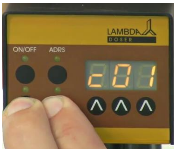
Figure 2-13: Appuyer simultanément sur les boutons REMOTE et RUN Il apparaît alors le message "c01" sur l'afficheur. Ceci indique que le programme sera exécutée une seule fois et le distributeur de poudre s'arrête ensuite.
