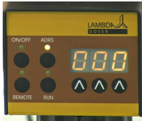
Figure 2-12: Laisser la valeur de débit à 0 (000). Cela marque la fin du programme.
