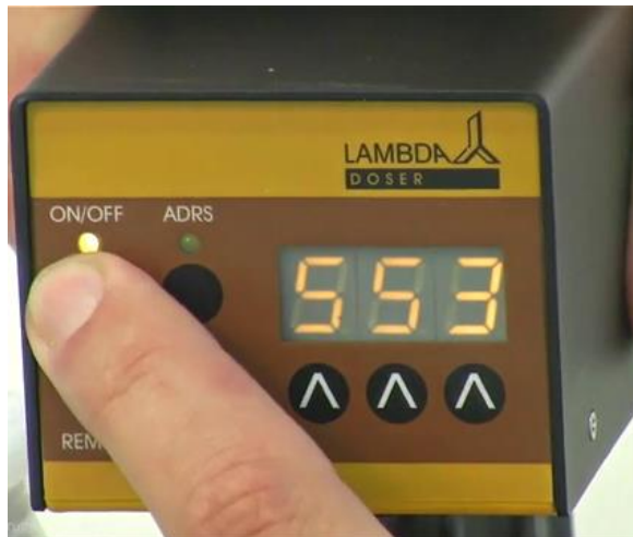
Figure 1-14: Presser ensuite la touche ON/OFF de l'unité de contrôle du moteur après avoir choisi la vitesse.
