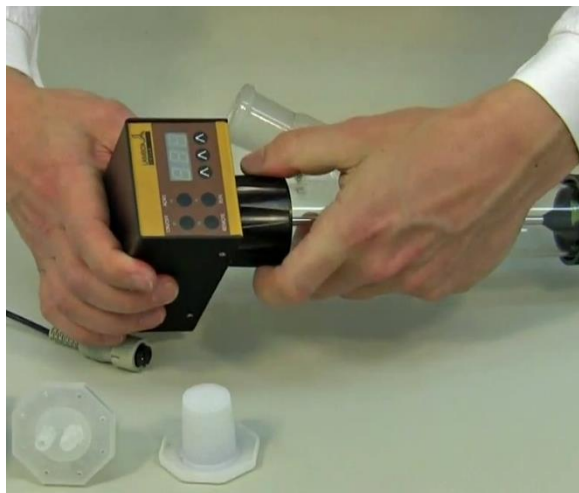
Figure 1-10: Enfoncer l'axe de l'unité motorisée entièrement dans la pièce de centrage. Il faut que la broche métallique de l'unité motorisée s'insère dans l'une des six encoches de l'unité de centrage. Ceci assure une parfaite étanchéité du doseur et une pression suffisante sur le disque de téflon dans le fond du récipient.
