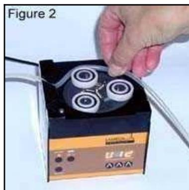
Fig. 2: Insérez le tuyau
