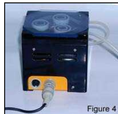
Fig. 4: Rückseite der Pumpe
