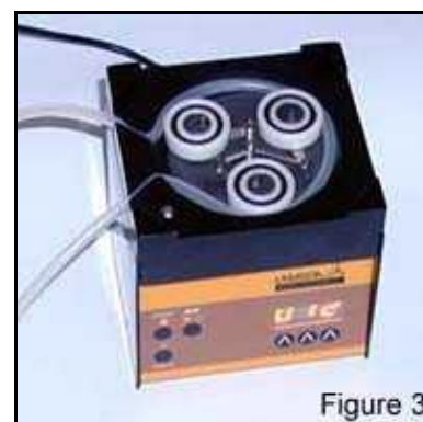
Fig. 3: Tubo nella testa della pompa
