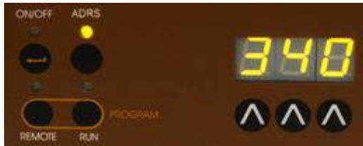
Abbildung 1.3-1 Display und Tasten auf der Bedienungskonsole des LAMBDA LUMO Lichtreglers
