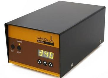
Das Red-Ox Potential kann mit dem Laborfermenter-Bioreaktor LAMBDA MINIFOR mit Hilfe einer sterilisierbaren kombinierten pH/Temperatur-Sonde mit zusätzlicher Pt-Elektrode gemessen werden. Diese Sonde wird in gleicher Weise wie die Standard pH und Temperatur-Sonde an den MINIFOR Fermenter-Bioreaktor angeschlossen.
