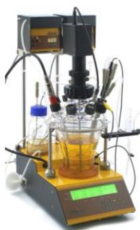
8. 空气流量控制: 0-5 l/分钟, 由最小刻度0.1 l/分钟的流量计控制,
