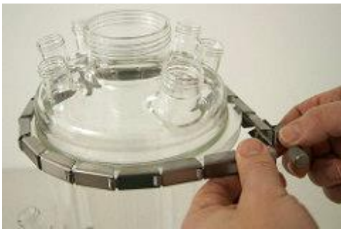
Fig. 13 Montage de la cuve du réacteur 7L
